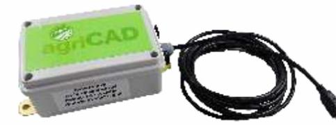
Sistema di telediagnosi per controllo temperatura, elettrico, pressioni, movimenti fino a 32 sensori.
