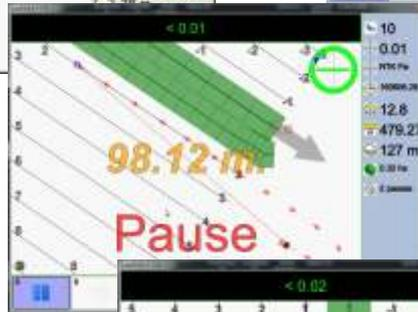
Funzione pausa con indicazione della posizione del trattore e del punto di ripresa della lavorazione.
