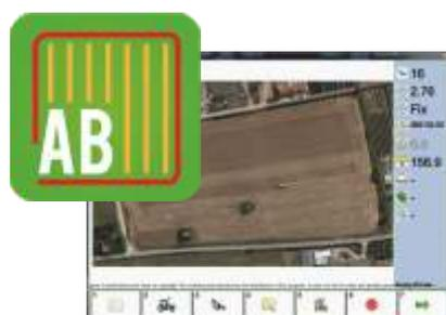
**A - B CONTORNO** - il software richiede prima il tracciamento del contorno del terreno da lavorare e poi l'allineamento AB delle linee interne. Possono essere fatte più passate parallele sul contorno
