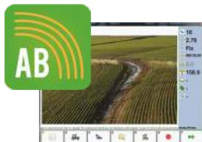
**A - B CURVO** - il programma genera una serie di linee parallele CURVE. Le nuove passate possono essere tutte parallele alla prima linea AB oppure può essere presa in considerazione l'ultima fatta.
