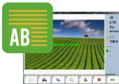
**A - B DRITTO** - il programma genera una serie di linee parallele dritte da seguire per ottenere una lavorazione uniforme
